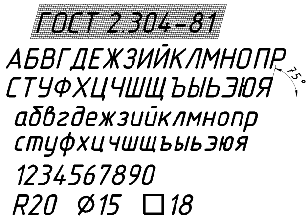
Рис. 4. Образец шрифта типа Б с наклоном
