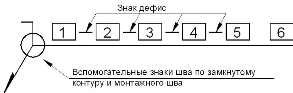
Рис. 9. Структура обозначения сварных швов
